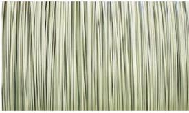
**JITEC FRP** : joncs composites obtenu par trempage de fibres continues avec une résine thermodurcissable.
