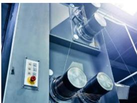
**YARNTEC** : filage mono ou bi-composants en voie fondue. Cet équipement permet de mettre en œuvre tous les polymères thermoplastiques, tels que : PE, PP, PA, PET, PPS, PEI, PEEK etc...
